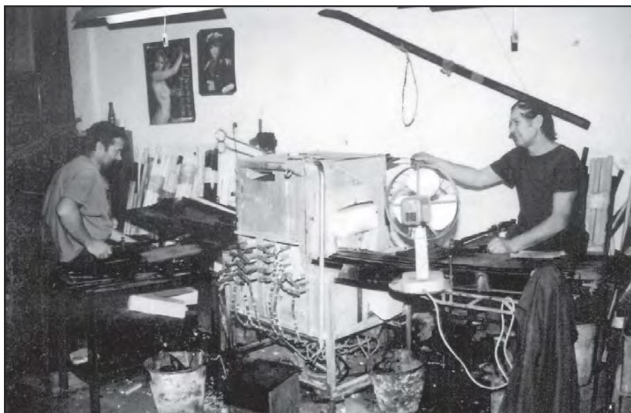
Obr. 5 Mačkání u „dvojmužné pece“. Otop elektřinou. HG Hraničná. Foto Diana Fitzgerald, 1993.
