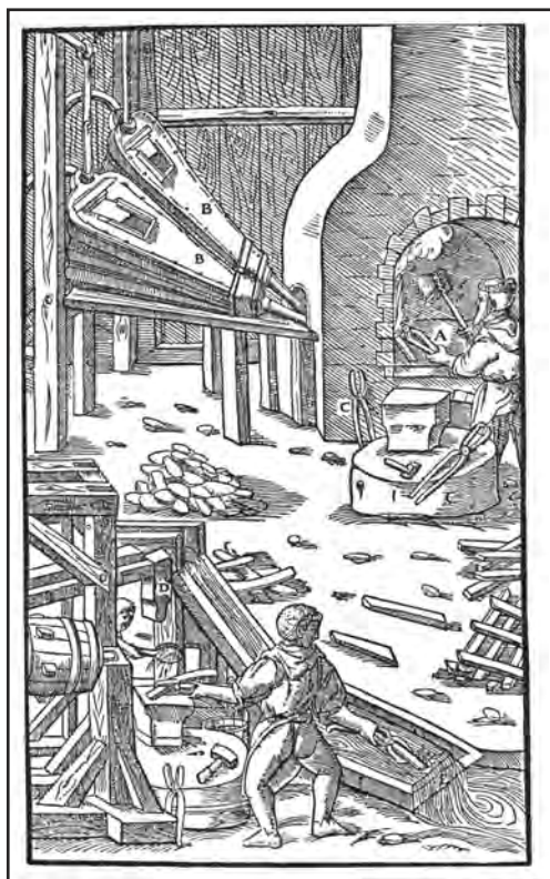
Obr. 3 Buchar nadhazovacího typu z Agricolova díla 12 knih o hutnictví a hornictví z roku 1556.
