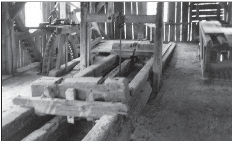
Obr. 2 Vnitřní vybavení pily (po směru technologického toku). Ve středu rámová pila s vozíkem, vlevo převodová stolice pohonu vozíku, vpravo omítací pila. Stav po vyklizení před počátkem obnovy. Foto Karel Janák, 2001.
