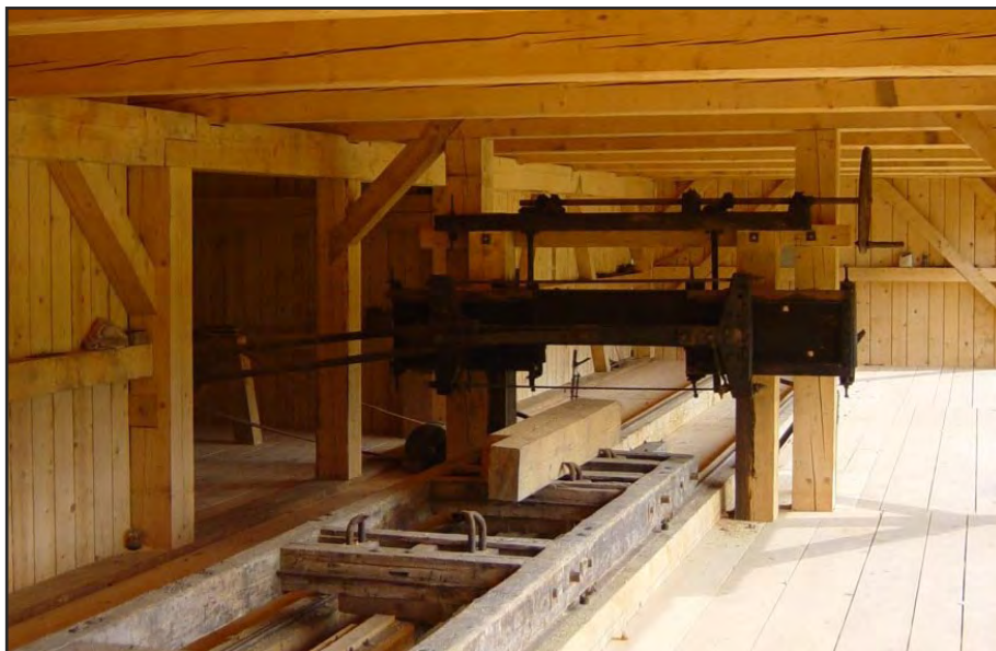
Obr. 3 Stroj pily osazený v pilnici a tzv. vozík – pohled z prostoru před strojem. Foto Petr Dostál, 2004.
