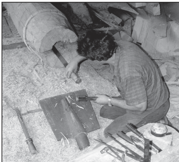
Obr. 3 Úprava hřídele vodního kola sekerníkem Josefem Kudrnou. Foto Jiří Merta, 2000.
