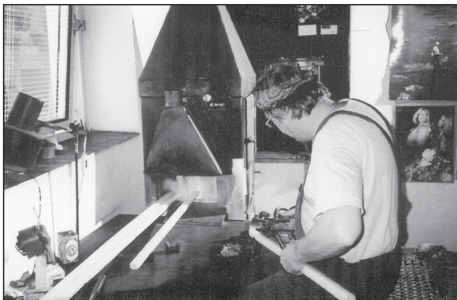
Obr. 6 Výroba skleněných knoflíků s kovovým ouškem v Nové Vsi. Foto Christa Petrásková, 1998.
